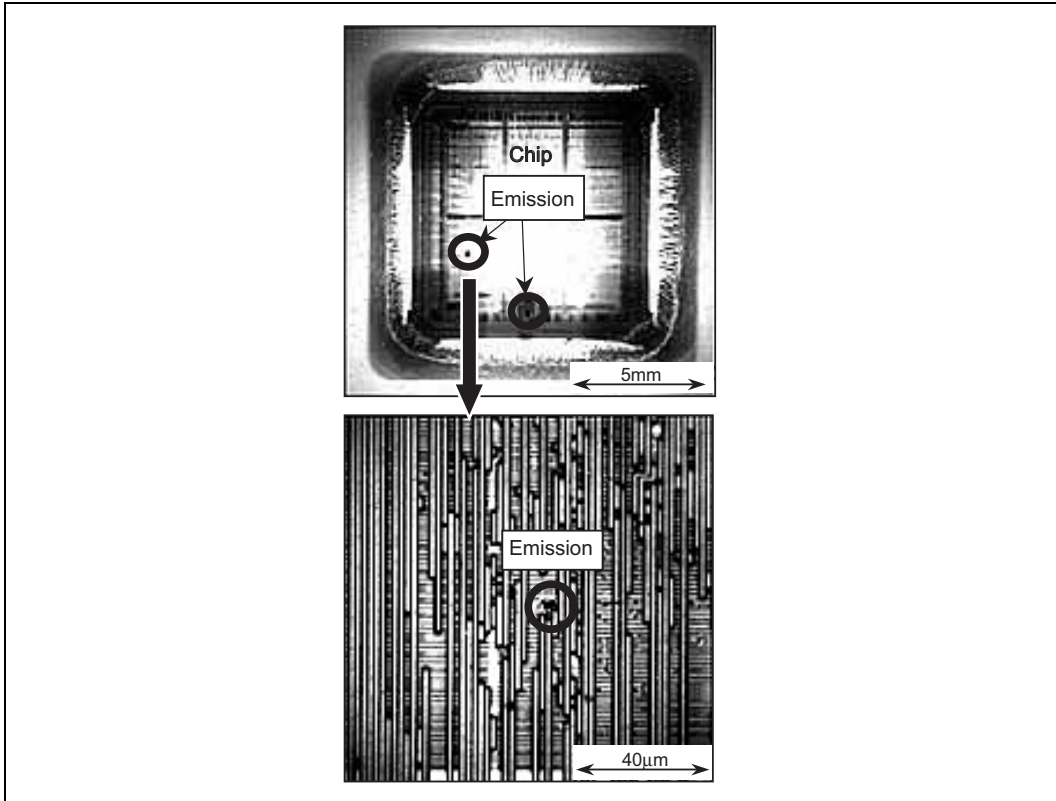
図 5.22 Iddq+発光解析によるロジック故障箇所検出例
